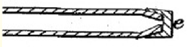
1847 Tapones fusibles en calderas de locomotoras de vapor. La tapa "e" se funde y libera vapor (patente de EE. UU. N.º 5022, Alfred Stillman)
